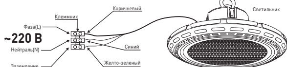
Рис. 1. Схема подключения светильника к сети 220В.
